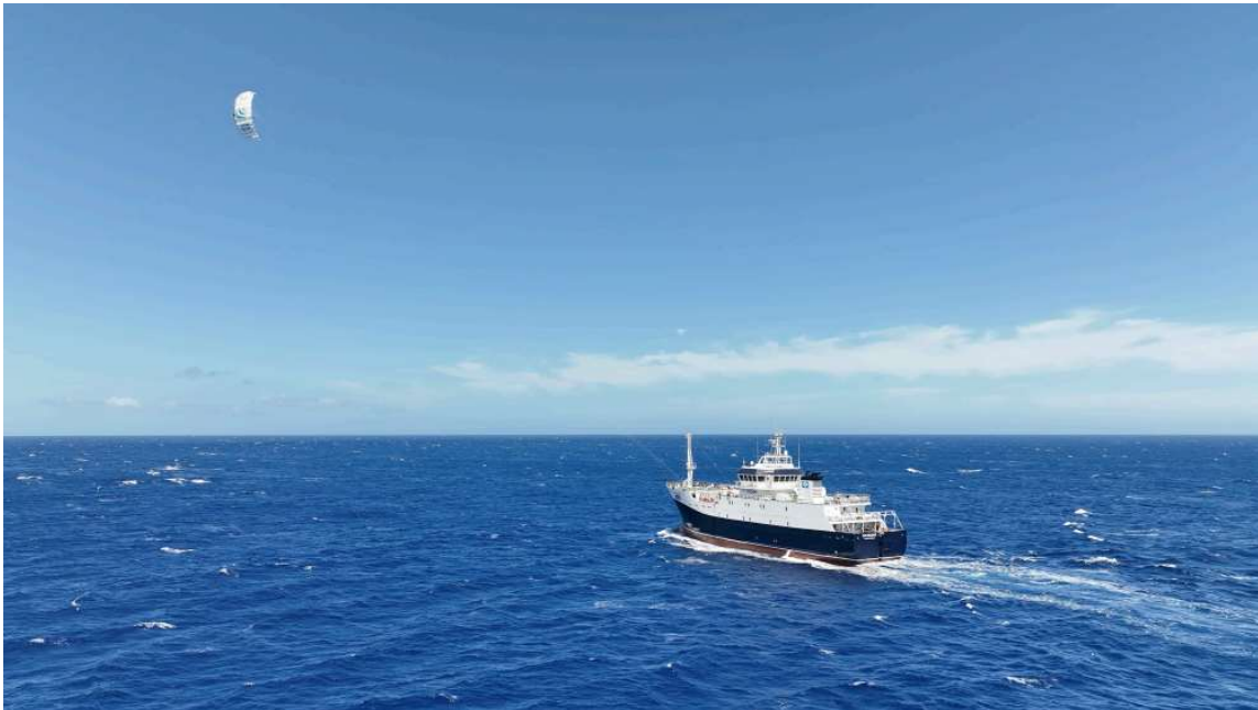
Le navire de pêche Cap Kersaint équipé d'un système SeaKite® de 100m 2 . Crédit ©Jérôme Balleydier
