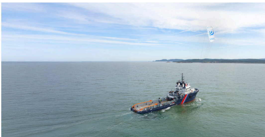
Le Jason des Abeilles International équipé d'un système SeaKite® - Crédit ©Les Abeilles International-Cellule Drone
